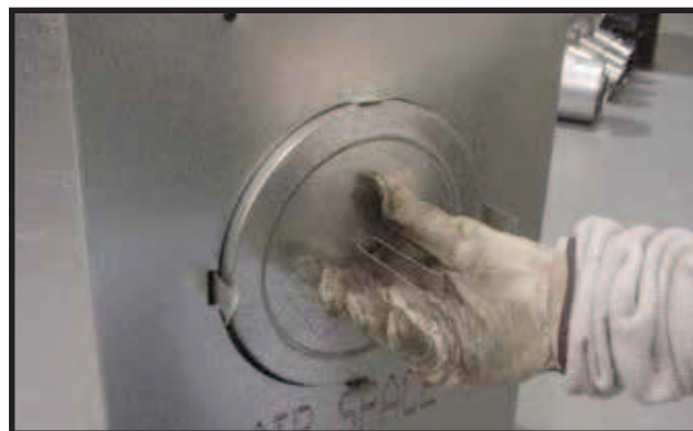
Figur 25. Bøy de midtre delene av båndet utover og bruk dem til å fjerne avtrekkshetten.
