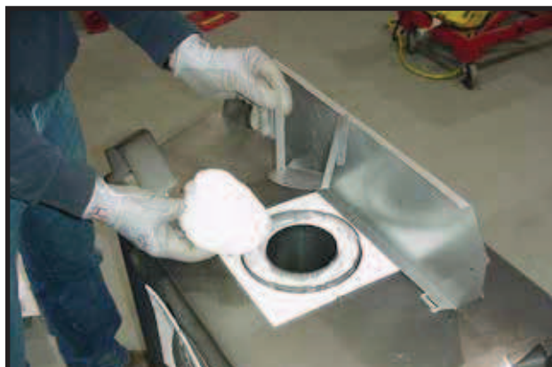
Figur 20. Fjern isolasjonskurven og den hvite isolasjonen fra det midtre avtrekksrøret.
