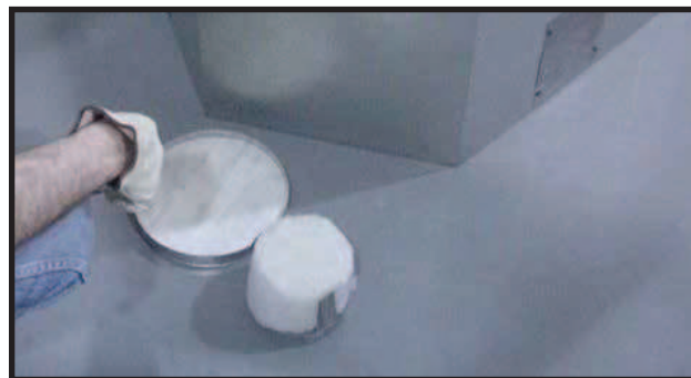
Figur 26. Kast avtrekkshetten. Fjern og kast isolasjonskurven. Merk: Når avtrekkshetten er fjernet, kan den IKKE settes på igjen.
