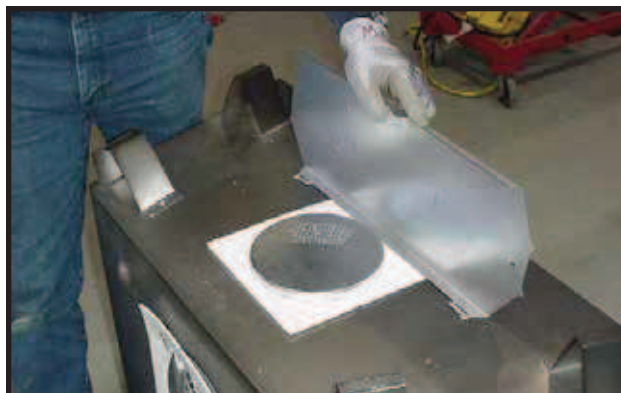
Figur 17. Roter varmeskjoldet på toppen slik at det står i vertikal stilling som vist over. Varmeskjoldet må stå i vertikal stilling.
