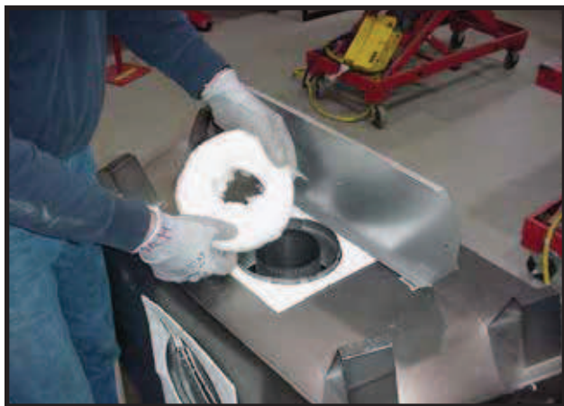
Figur 21. Fjern isolasjonen fra det ytre avtrekksrøret.
