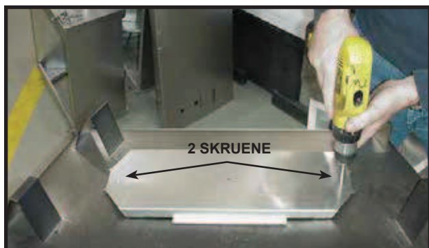
Figur 16. For toppavtrekk, fjern de to skruene som holder varmeskjoldet på toppen på plass. For avtrekk bak, se neste side.
